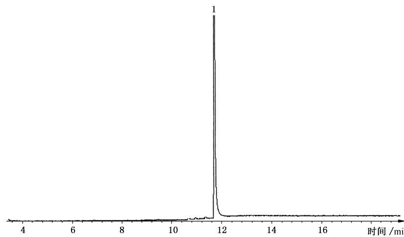
图 B. 4 邻苯二甲酸二辛酯标样的 GC/MS 总离子流图
