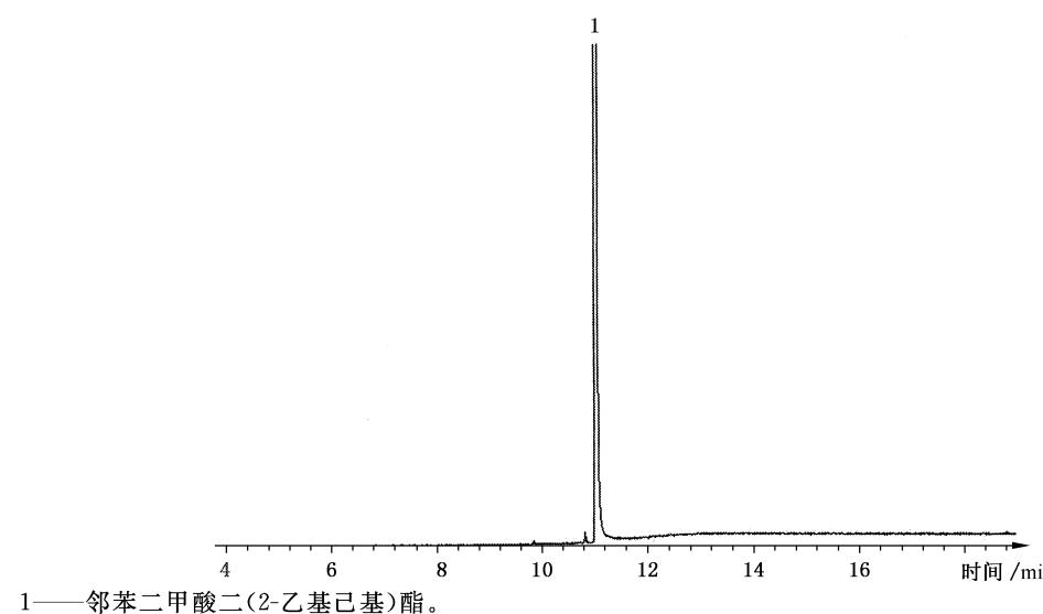
图 B. 3 邻苯二甲酸二(2-乙基己基)酯标样的 GC/MS 总离子流图
