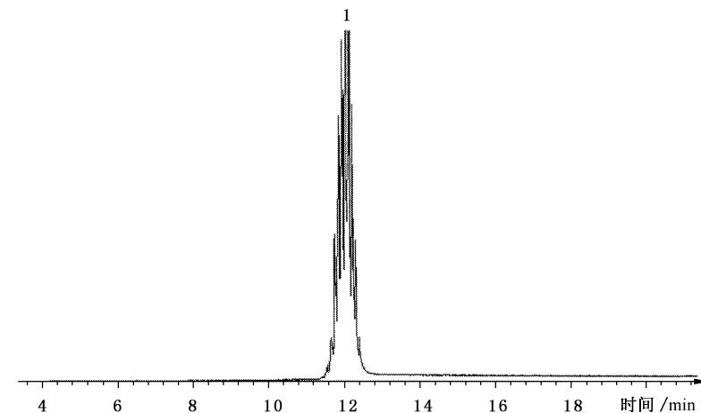
图 B. 5 邻苯二甲酸二异壬酯标样的 GC/MS 总离子流图
